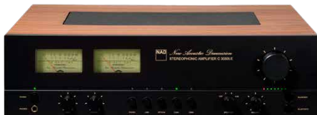
Die optische Verwandtschaft zum 3030 von 1974 ist unverkennbar. Die modernen Bauteile des C3050 LE beanspruchen aber deutlich weniger Platz als der diskrete Aufbau samt dickem Trafo beim 3030.
