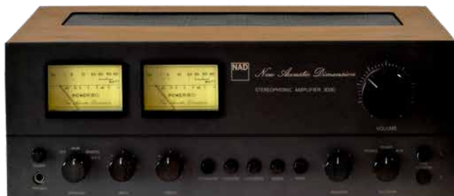
Die optische Verwandtschaft zum 3030 von 1974 ist unverkennbar. Die modernen Bauteile des C3050 LE beanspruchen aber deutlich weniger Platz als der diskrete Aufbau samt dickem Trafo beim 3030.
