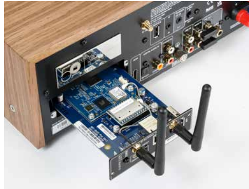
Das MDC-Modul enthält den Streamer des BluOS-Systems und die Dirac-Raumkorrektur.
