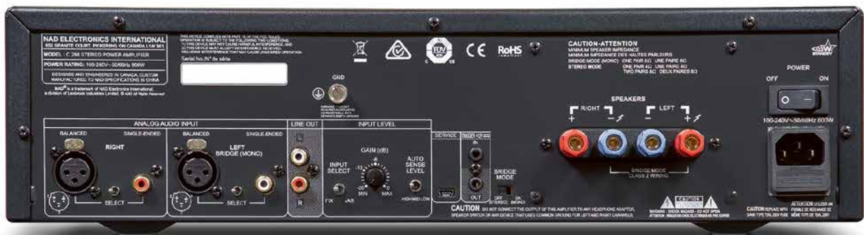
Ungewöhnlich vielseitige, aber praxisnahe Ausstattung für eine Endstufe mit Cinch- und XLR-Eingängen, Cinch-Ausgang, Pegelregler und Mono-Brückenschalter.
